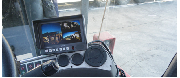
Monitor 7" en cabina con partición de pantalla QUAD
